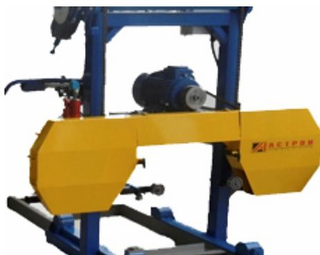
**Ленточнопильный станок** предназначен для продольной горизонтальной распиловки бревен и брусьев различных длины и толщины, как обрезной, так и не обрезной древесины хвойных и лиственных пород, диаметром до 850 мм.
